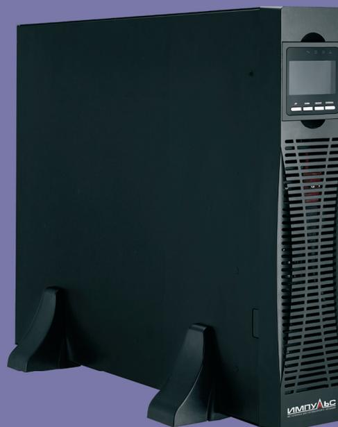
ИБП данной серии представляют собой интеллектуальные высокочастотные ИБП двойного преобразования (OnLine) с однофазным входом и однофазным выходом. В серию входят две модели устройств, мощностью 6 и 10 кВА. Несколько модулей ИБП могут соединяться параллельно и обеспечивать схемы резервирования N+X. Установка ИБП в параллель позволяет гибко наращивать суммарную мощность системы в зависимости от роста нагрузки и оптимизировать затраты в соответствии с текущим уровнем потребляемой мощности.
