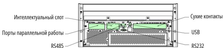
(б) 10-30 кВА с отсеком для встроенных АКБ
