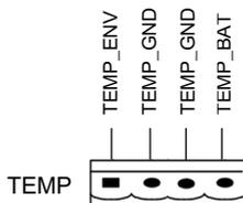
Рисунок 3.10. Порты TEMP 1-4 для определения температуры
