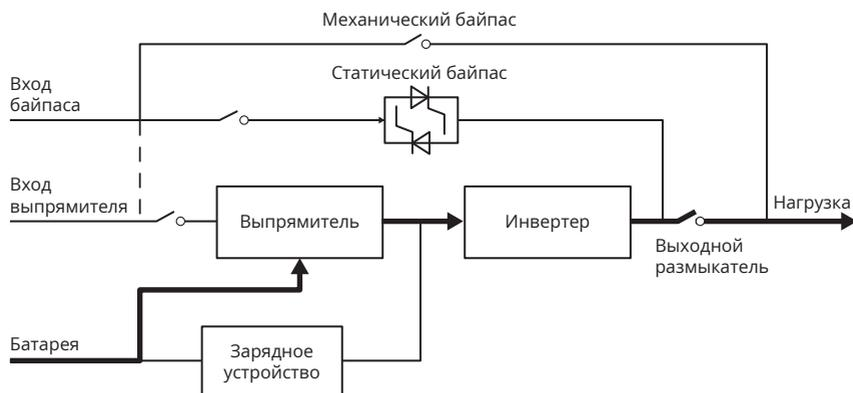
Рисунок 2.5. Функциональная схема ИБП при работе от АКБ
