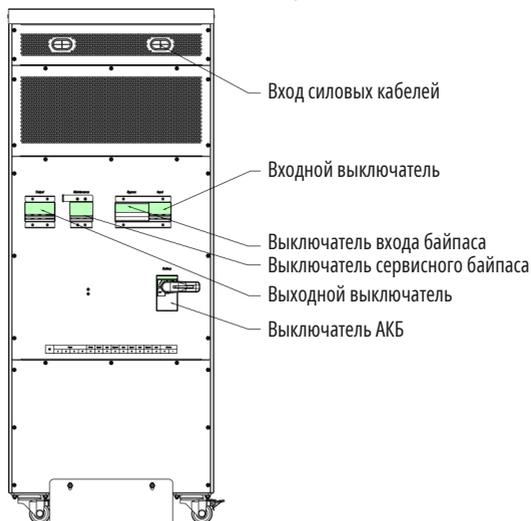
(ж) ИБП мощностью 60-80 кВА с отсеком для встроенных АКБ, вид сзади
