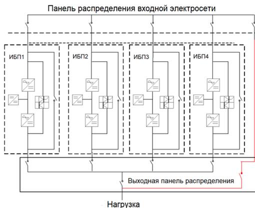
Рисунок 5.3. Схема параллельного подключения
