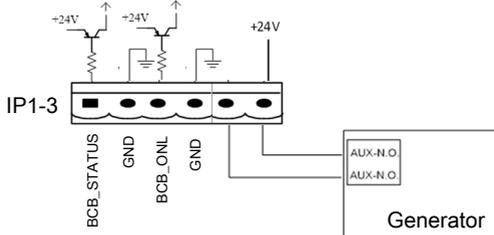
Рисунок 3.11. Схема входного порта для входа генератора
