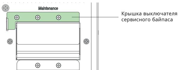
Нагрузка в этом случае будет запитана параллельно через цепи статического и механического байпасов.
