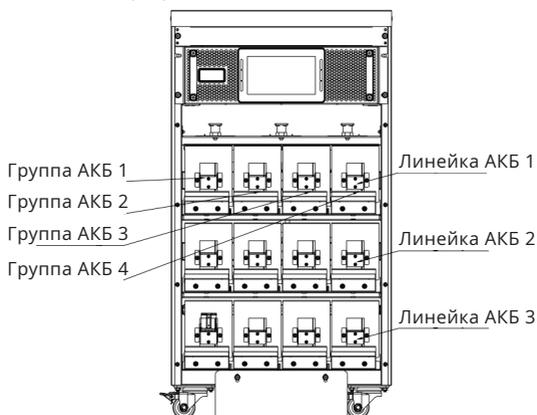
3. Необходимо подключить положительный, отрицательный и средний выводы каждой линейки АКБ к соответствующим разъемам ИБП, как показано на рисунке ниже. При этом необходимо строго соблюдать схему и полярность подключения.
