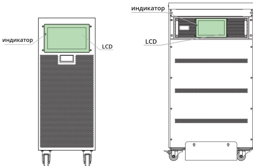
(а) ИБП мощностью 10 - 30 кВА, вид спереди
