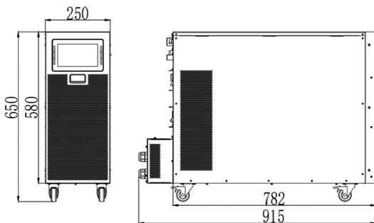
(в) 40 / 60 / 80 кВА без отсека для встроенных АКБ (ед. изм.: мм)
