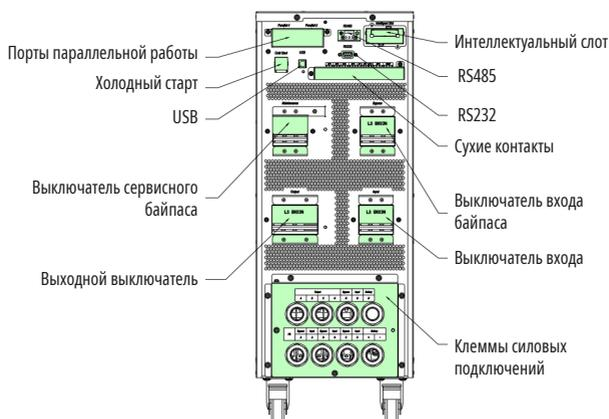
(а) 10-40 кВА без отсека для встроенных АКБ
