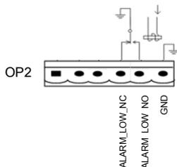
Рисунок 3.14. Схема интерфейса выходного релейного контакта общей тревоги
