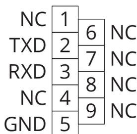
Соединение между портом компьютера RS232 и портом ИБП RS232
