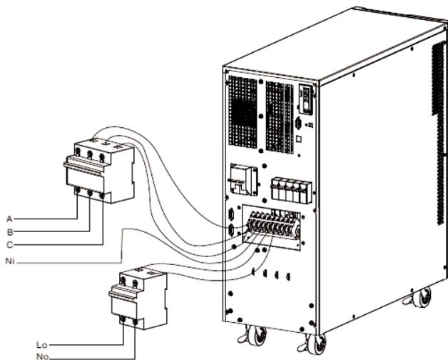
Рис. 4. Подключение дополнительной аккумуляторной батареи
