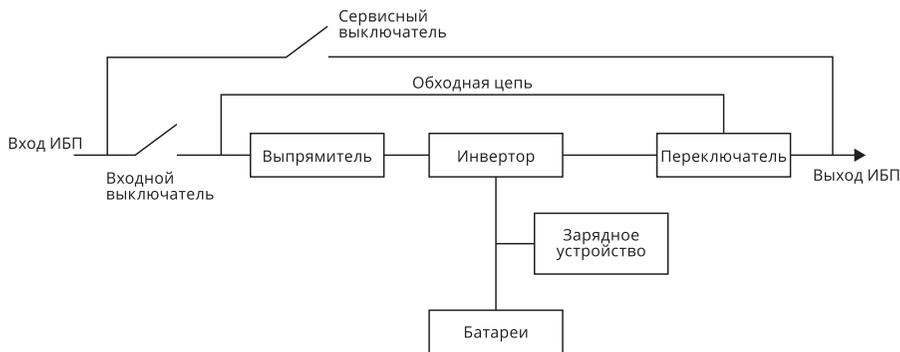
Рис. 1-1 Блок-схема ИБП
