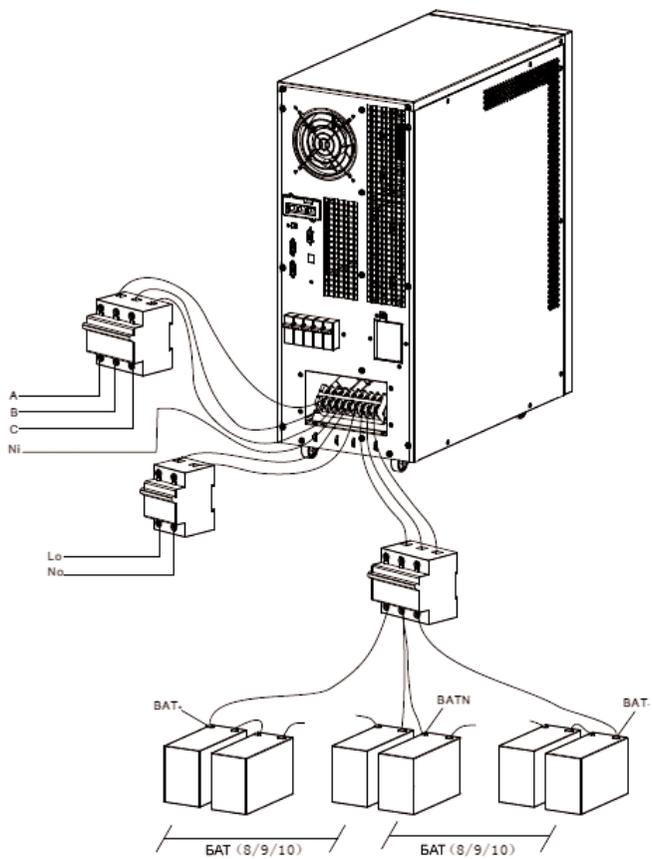
Рис. 5. Подключение внешней аккумуляторной батареи к ИБП 10/15/20 кВА без встроенных АКБ
