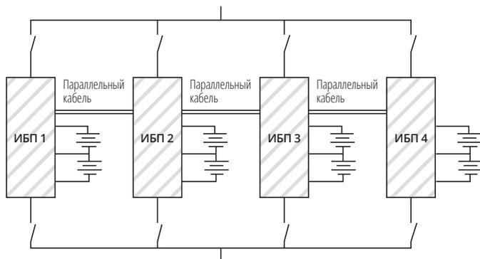
Рис. 7. Параллельная система
